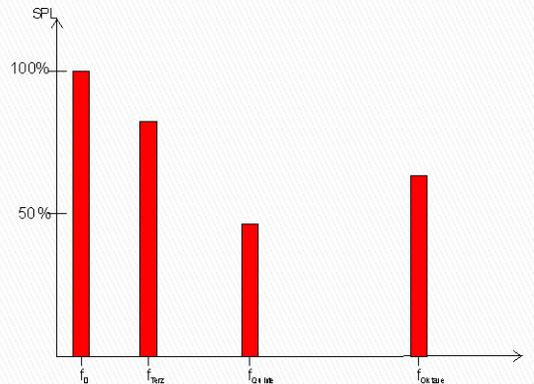
$$s(t) = s_0 + s_1 \cdot \cos(1 \cdot \omega_0 \cdot t + \varphi_1) + s_2 \cdot \cos(2 \cdot \omega_0 \cdot t + \varphi_2) + s_3 \cdot \cos(3 \cdot \omega_0 \cdot t + \varphi_3) + \dots$$
